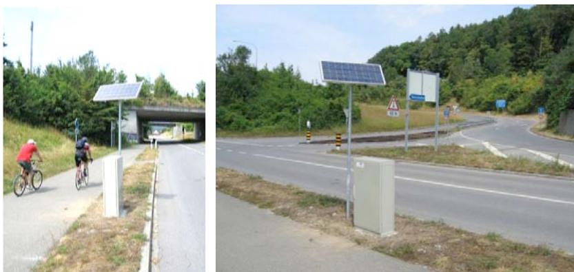
**Bild 1:** Zählstelle Hemishofen SH (Zählschrank mit Solarpanel)
