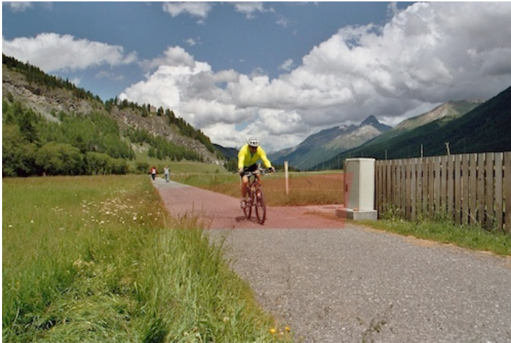
Bild 1: Zählstelle La Punt GR (Zählschrank mit Darstellung des unsichtbaren Radarstrahles)
